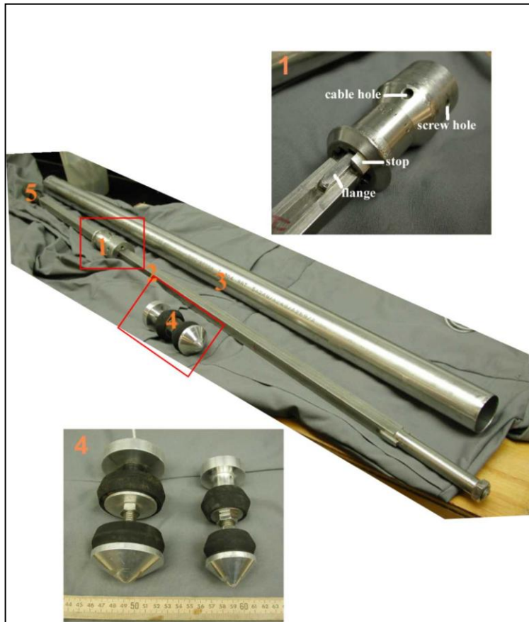
řekil 2.1.2. Livingstone karotiyer ve blmleri.
