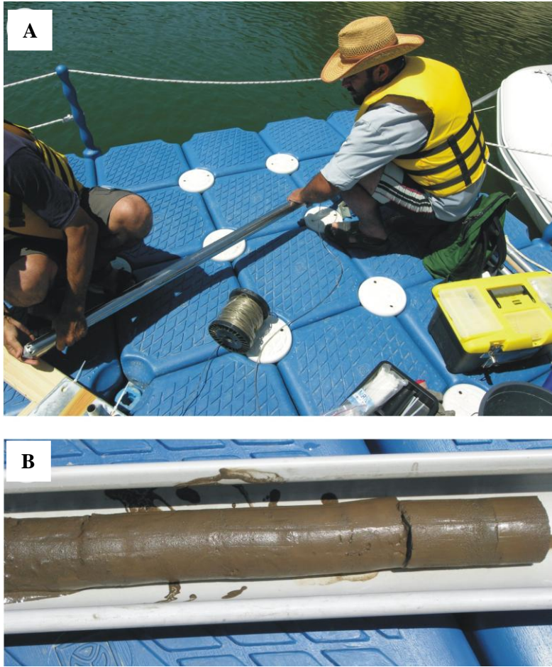
Şekil 2.1.3. A) Livingstone corer ile karot örneği alınırken bir anlık. B) Alınan karot örneği.
