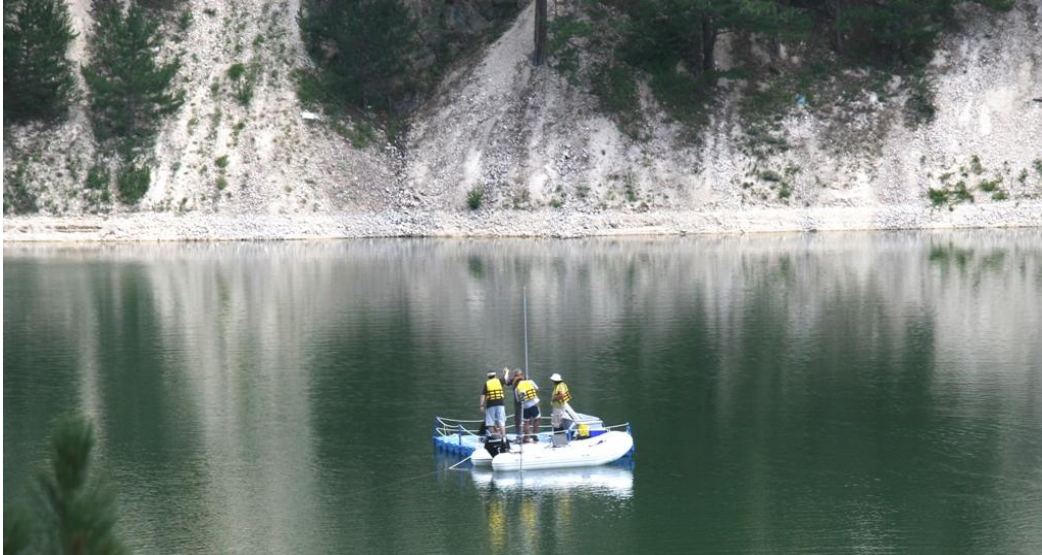
Şekil 2.1.1. Livingstone karotiyeri ile göl tabanından karot alımı.
