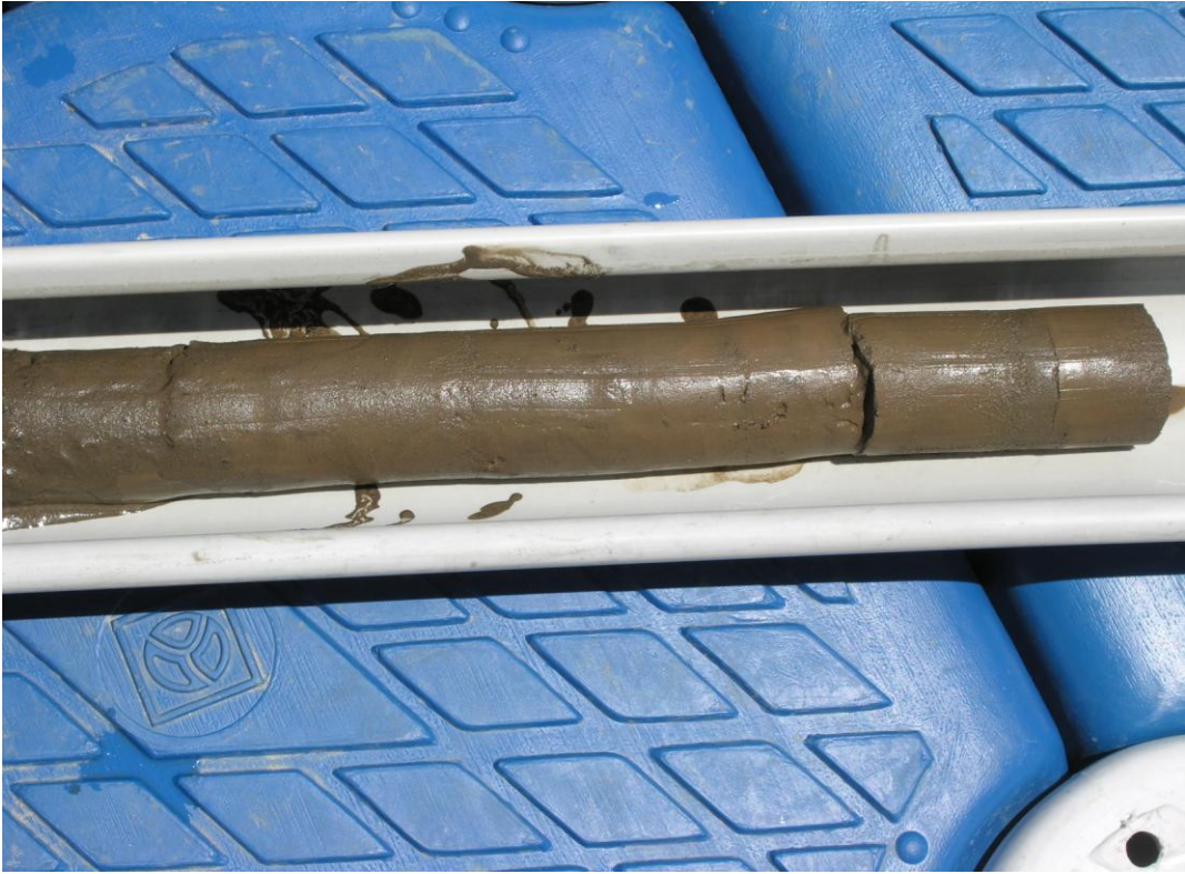
Şekil 3.39: Plastik boru içinde Sünnet Gölü karot örneği.
