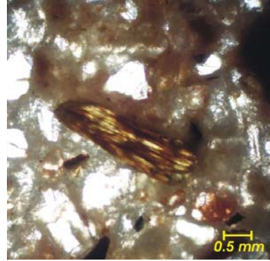
Şekil 4.61. KD-3 numaralı örnekte izlenen opaklaşmış bivotit
