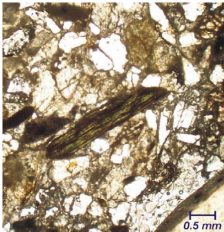
Şekil 4.55. Dn2-8 numaralı örnekte bulunan iri kalsit kristalleri ve opaklaşmış klorit.
